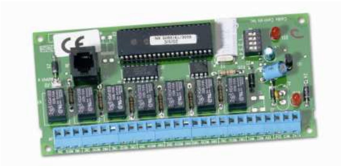
La NX-507E/NX-508 est un module avec microprocesseur pour des centrales anti-intrusion pour NX.
